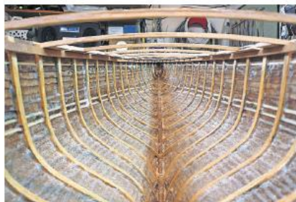
Ein Blick in den im Bau befindlichen Rumpf.
